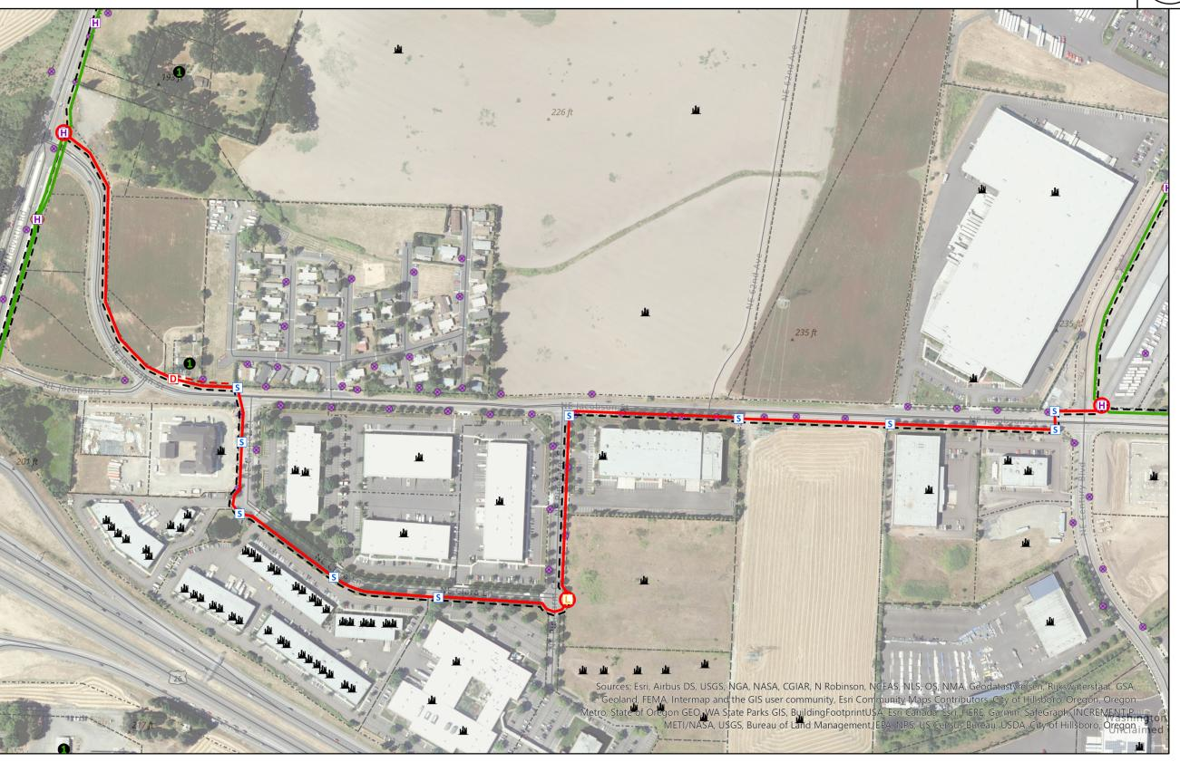
\*\*\*\* NOTE \*\*\*\* CONDUIT SHOULD BE PLACED IN THE PUE WHERE AVAILABLE
