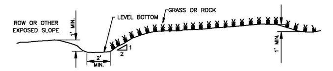
BOTTOM WIDTH 2 FEET MINIMUM; THE BOTTOM WIDTH SHALL BE LEVEL
